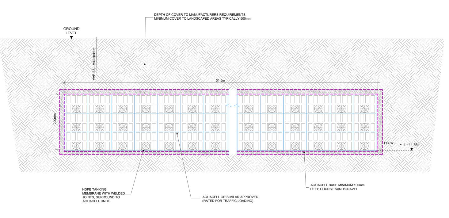
TYPICAL AQUACELL TANK LONGITUDINAL SECTION
