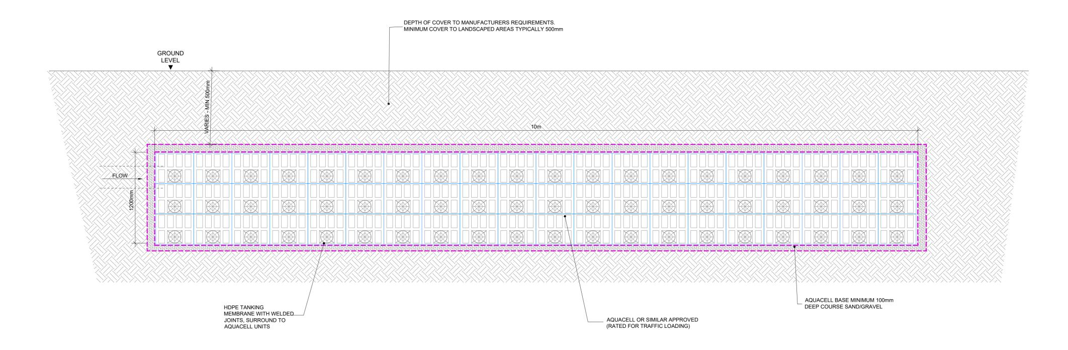
TYPICAL AQUACELL TANK CROSS SECTION
